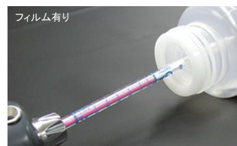
アンモニアが検知されず元のピンク色のままで変化しない
